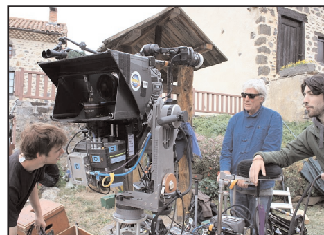
Rig Binocle, caméras Génésis Panavision, moniteur contrôle Transvidéo
